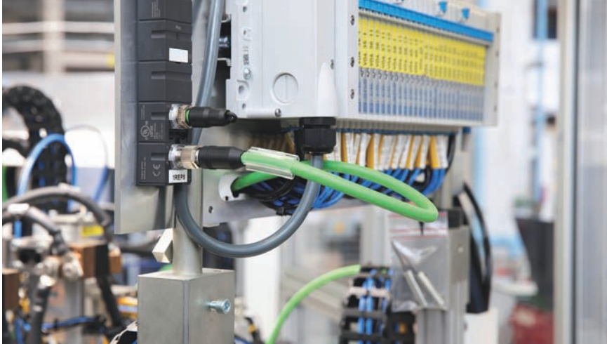
Pomocou prípojky ventilových ostrovov Cube67 možno ovládať ventily ľahko a priamo na mieste.
