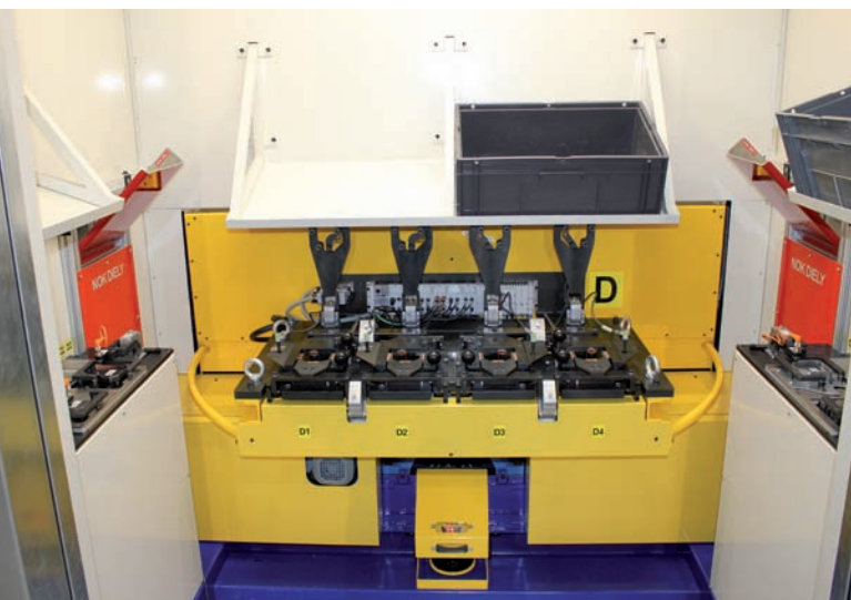
Vstupná strana bunky s pneumaticky riadenými upínacími prípravkami a výklopnými podávačmi (sivé kryty naľavo a napravo, červené kryty sú na NOK DIELY), ktoré presúvajú zvarence na dopravníky. V strede na spodku je umiestnený skener snímajúci prítomnosť obsluhy vo vstupnom priestore.
