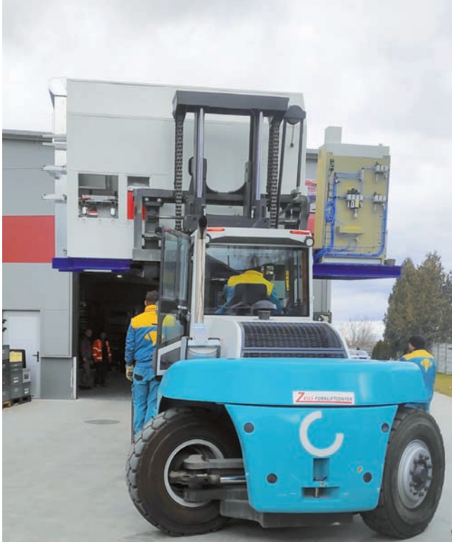
Robotickú bunku možno premiestňovať v rámci výrobných priestorov ako jeden celok.
