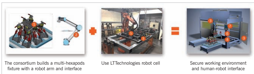
Obr. 9 Koncept projektu HWFlexCell (1 – hexapod, 2 – robotické rameno, 3 – snímače, 4 – PLC, 5 – dátové rozhranie, 6 – softvér na programovanie bunky, 7 – intuitívne rozhranie človek – stroj) (vlastníctvo DIH 2 )
