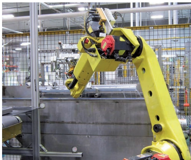
Vďaka automatickému odhroťovaniu a umývaniu častí vnútri bunky je jeden operátor schopný obsluhovať dve bunky. (Foto: © Alexandria Industries)
